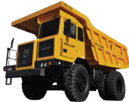
CAMIÓN FUERA DE TERRENO MDT 430 MOTOR: SCANIA 350Hp/2100rpm PESO OPERACIONAL: 19.3TN
