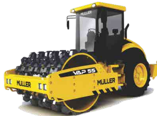
COMPACTADOR VIBRATORIO VAP55 MOTOR: PERKINS 100hp 2220 rpm DE 7.0TN A 9.7TN
