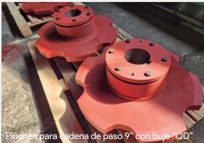
Piñones para cadena de paso 9" con buje "QD"
