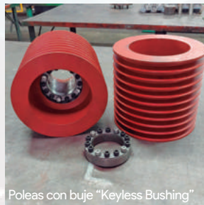
Poleas con buje "Keyless Bushing"
